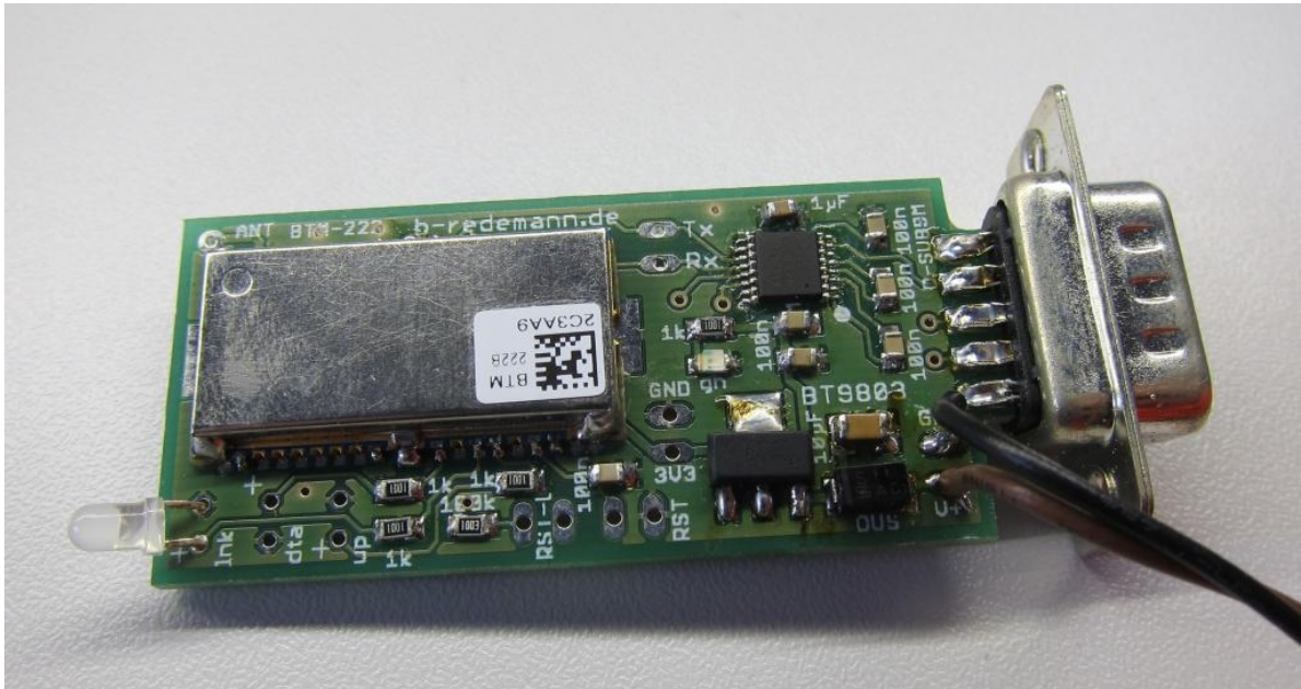
Schritt 1: Bestückte Leiterplatte mit dem BTM222
